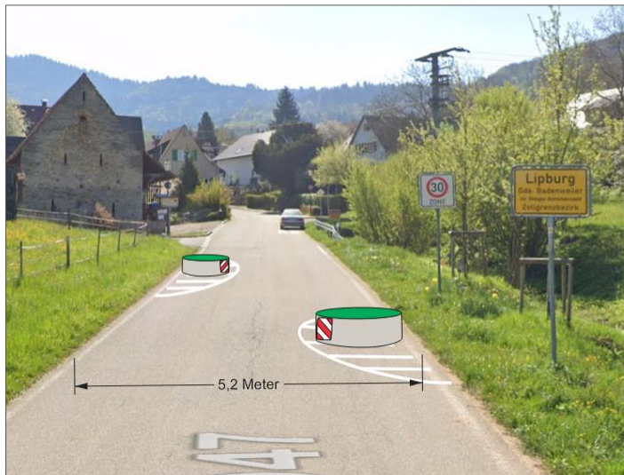
Abbildung 47: Darstellung Fahrbahnverengung Ortseingang West Lipburg
